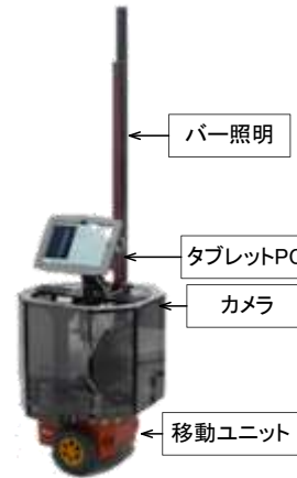
図 2: キズ検査ロボットの外観
