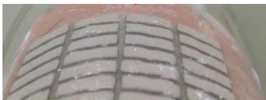
図 5. 先行研究において作製された 32 対熱電モジュールの湾曲状態。
