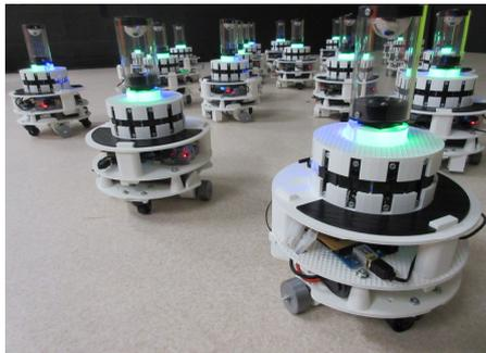
図1：製作したロボティックスワーム
