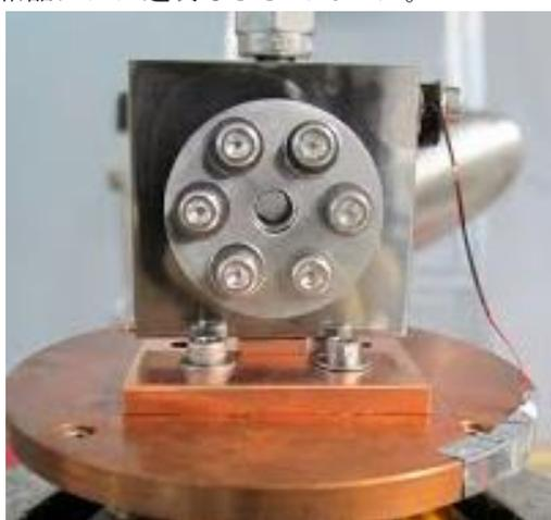
図 1 ダイヤモンド窓高圧固体水素セル
