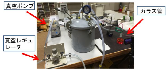
図6 繊維束内外の浸透性評価装置
