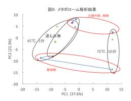
当帰の湯もみ温度について45度と70度では生産される生薬の品質が大きく異なることを明らかにした。この品質の差は、根の径による部位別に試験を行うことで評価できる。また、根の太さにより湯もみ温度を変える必要があるなど条件設定についても有益な情報を提供できる。
