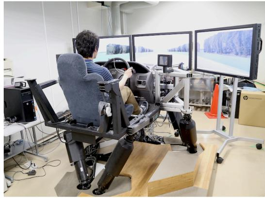
図-6 路面評価型DSによる走行試験状況
