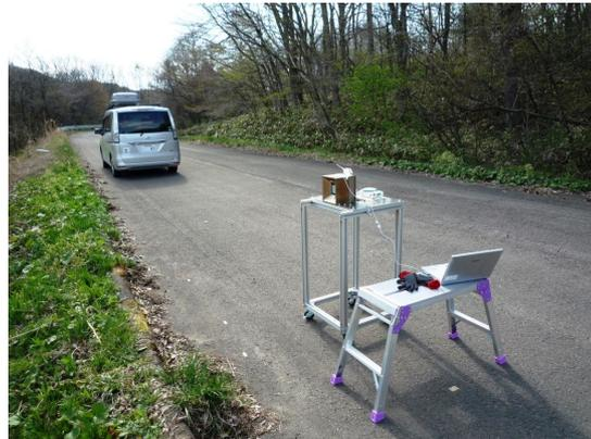
図6. 補正係数導出のための車外測定の様子。重量物の遮蔽体付検出器1台を専用の架台に取り付けて、1方向ずつ測定を実施した。写真は左方向を測定時のもの。
