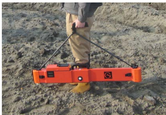
写真1 EM38による地下塩分濃度の調査
