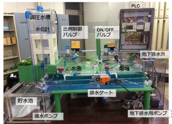
写真2 作成した圃場貯水・ブロック排水小型模型 (自動通信制御が可能)
