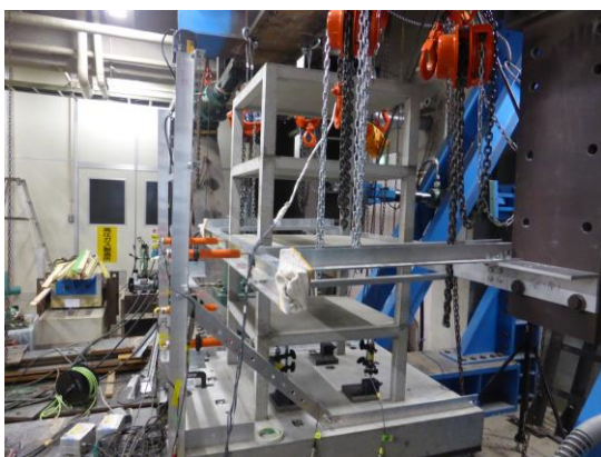
写真 3 純ラーメン構造試験体の静的加力実験 （東京大学地震研究所）
