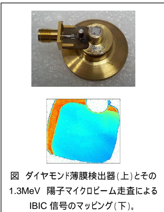
図 ダイヤモンド薄膜検出器(上)とその
