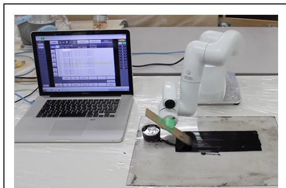
図6 ロボットアームによる漆塗り
