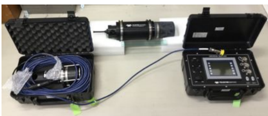
図4 調達した ATM966-LS2 型音響モデム(上)。左右の黒箱内の装置は、ATM966-LS2 の船上制御ユニット(右)とそれに附属のトランスジューサ(左)である。
