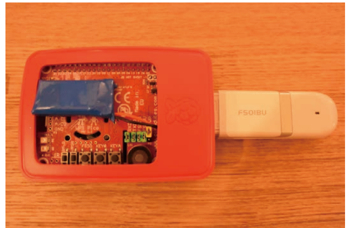
図3 Raspberry Pi 2 Model B に UPS Pico と 3G ドングルを付設したゲートウェイ
