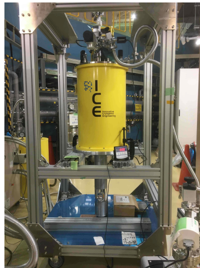
図1 J-PARC MLF MUZE (J-PARC 物質生命科学実験施設 ミュオンビームライン)に設置されたクライオ・ファーネス(通称ドライレモン)。無冷媒で試料温度範囲は1.5-800Kである。
