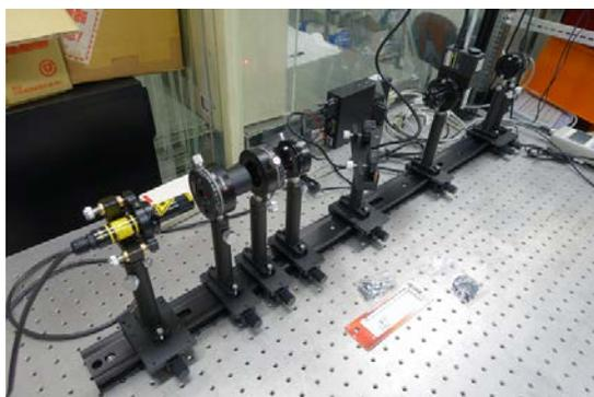
図5 導入した偏光能率自動評価システム。光路中央部に 110mm×110mm のワイヤグリッド基板が光軸に対し  $45^\circ$  傾けて設置されている。
