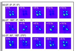
図3 異なる位相パターンで励起した後の固体パラ水素結晶中の2×2スポット型振動励起状態の時間発展。(a)位相差なし (b) 隣接するスポット間に180°の位相差をつけた場合 (c) 隣接するスポット間に90°の位相差をつけた場合。
