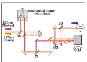
図1:位相変調素子を導入した干渉計の光路図。 DI:ダイクロイックミラー, BS:ビームスプリッタ, MS:マイクロステージ。
