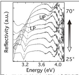
図 2 TDAF マイクロキャビティの角度依存反射 スペクトル。LP は lower polariton 分枝、UP は upper polariton 分枝を示す。
