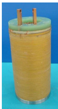
図 1 Bi-2223 超伝導コイルの緒元
