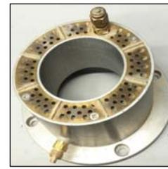
図2. 中空ねじり試験用ペDESTAL
