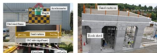
図-2 大型緩衝材実験装置と敷砂緩衝材を設置した実規模ロックシェド模型
