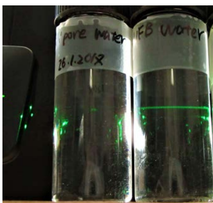
図8 超純水中でのUFBのレーザー散乱 (左：超純水、右：UFBが浮遊する超純水)
