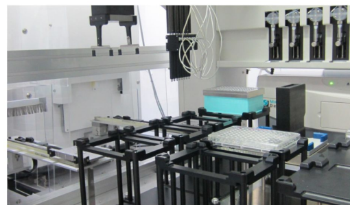
図3: ラボオートメーションを用いた全自動進化実験システムの外観。
