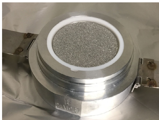
図2 焼結金属板をリテーナーに使用したバックアップフィルタホルダ
