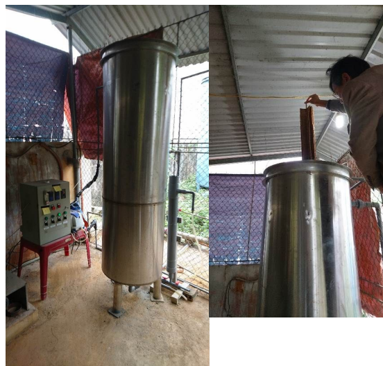
写真 1 ハナム省現場の SNAP リアクター 左:500L 容 SNAP リアクターおよび硝化リアクター、右: SNAP リアクター内の担体
