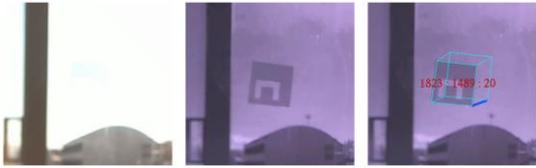
図 2 熱反射フィルムマーカ (赤外線)
