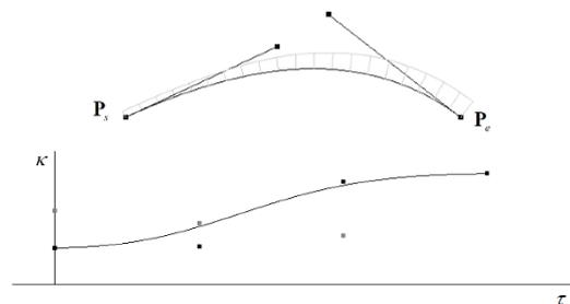
図4 3次の有理 explicit Bézier による  $G^2$  Hermite 補間。生成された曲線(上)と曲率プロット(下)。曲率プロットの濃い黒丸は制御曲率を、薄い黒丸はウェイトを表す。
