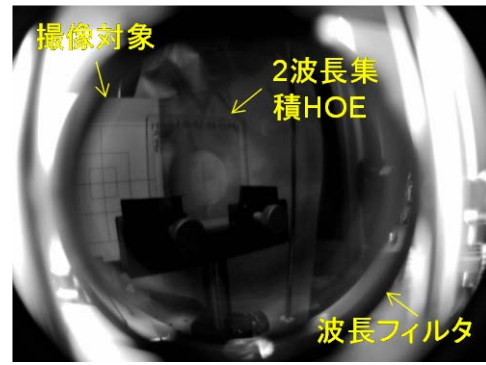
図 8 2 波長集積 HOE による撮像 (透過波長域が中心波長 632nm、半値全巾 10nm の波長フィルタを用いた場合)
