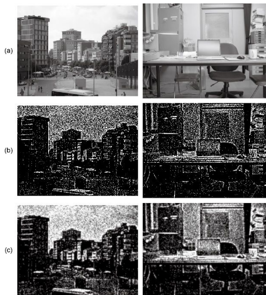
図4. 画像の符号化・復号化アルゴリズムによる結果。図(a)元の濃淡画像、図(b)2値化された画像、図(c)復号化された濃淡画像。(学会発表のProceedings論文から図の一部を引用)。
