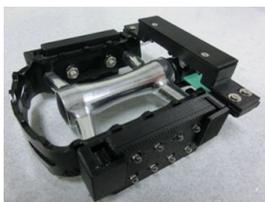
図3 回転形 LED ペダル振動発電灯火装置
