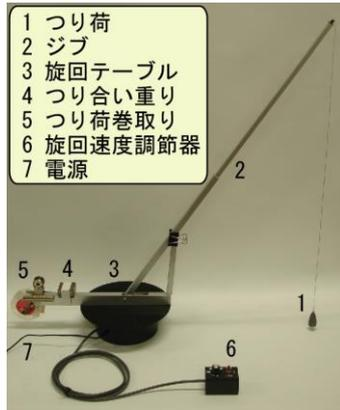
図 9 クレーンの実験装置
