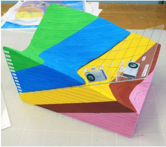
図6 地層の走向・傾斜を示すアナログ模型。
