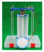
個体差が出ないよう、3D プリンタを用いた 軽量かつ統一規格のフレームを作成した。さ らに、発電効率を向上させるため、フライホ イール機構を用いることで、回転数が上がる ほど発電量が上がる(下グラフ参照)と同時 に、安定して回転を持続できるようになった。
