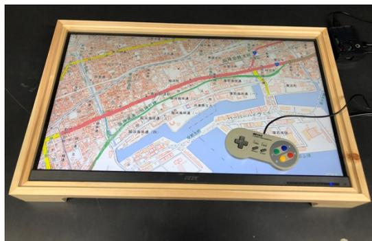
一般的なPC用モニターと、小型PCを組み合わせた安価な装置でありながら、安定して高精細な画像を切替えて表示できるようにした。またキーボードやマウスを用いずに、ゲーム用のコントローラーにより誰でも直ぐに操作できるインターフェースにした。
