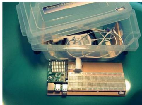
図 3 高専高学年向け Raspberry Pi 実験用セット
