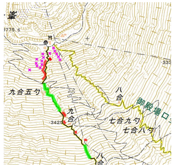
図7. 富士宮ルート上部の落石危険箇所
