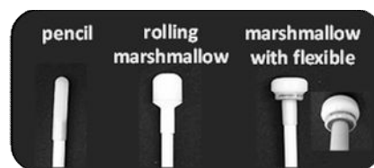
図2 実験に用いた石突の形状(右ペンシル型, 中央回転式マシュマロ型, 左クッション付きマシュマロ型)
