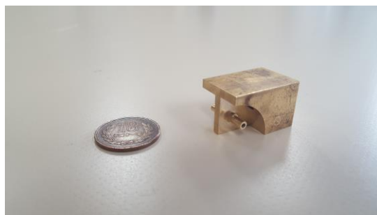
図 7 車軸を削り出したボディ
