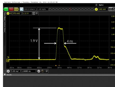
図 2. ゲート用電圧パルス波形 (50 Ω 終端、20dB 減衰後)
