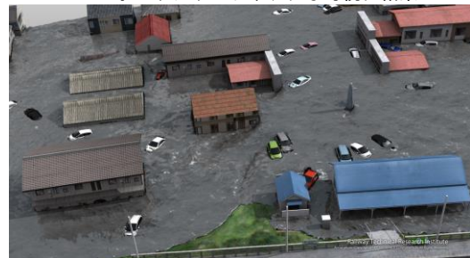
図11 第3の解析において自動車が浮遊する津波解析のフォトリアリスティックな可視化結果
