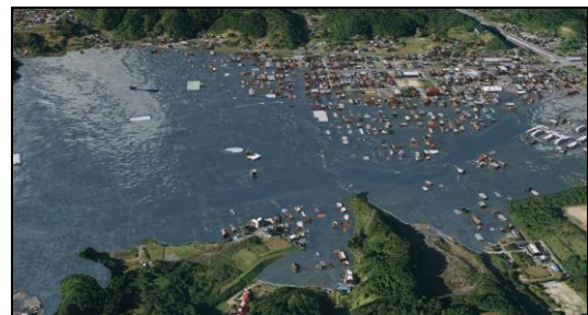
図10 第2の解析において巨大船舶が浮遊する津波解析のフォトリアリスティックな可視化結果
