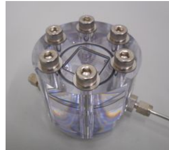
Fig. 8 ポリカーボネート製高圧マイクロチャンネルホルダー
