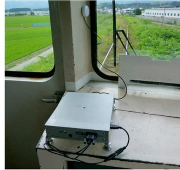
図2 小型レール診断装置
