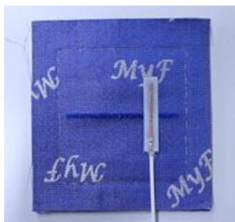
図1 給電マイクロストリップ線路を付けた導電性織物キャビティ付きスロットアンテナの写真。
