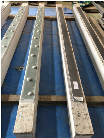
写真-1 補強後の供試体の状況
