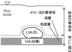
図-1礫床河川における粗度の多重スケール性(MSR)と本申請研究の考え方
