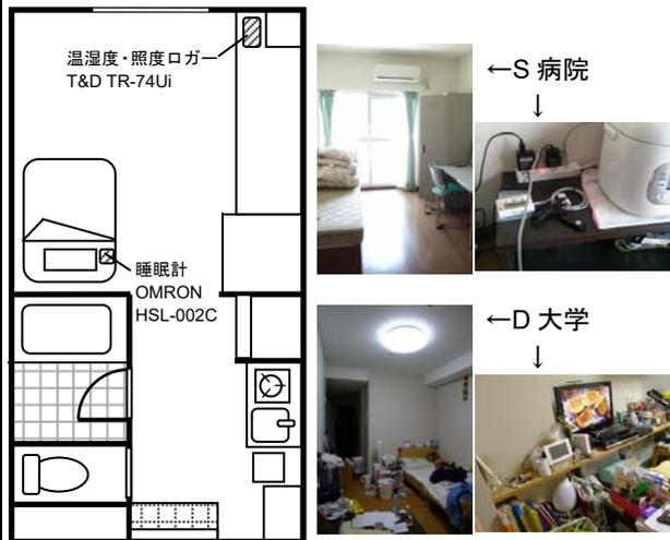
図1 調査対象室平面図と測定器設置状況
