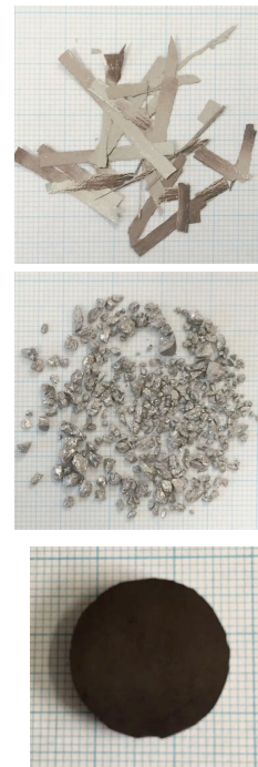
図1 合成試料の例 (上：金属間化合物の例メルトスパン法。中：金属間化合物の例溶解、粉碎材。下 EuS 焼結体)
