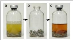
図 1. 好気的 SCC の準備 培地の赤色(c)はレサズリン色素によ る酸素の存在を示す。
