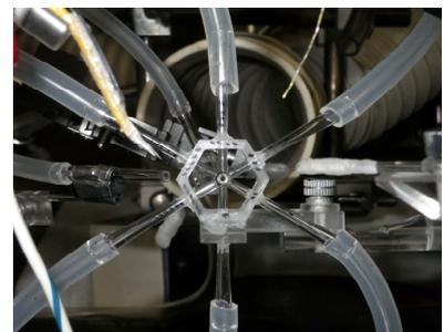
図 1 6 方向匂い刺激装置
