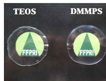
図1.セルロース/シリカハイブリッドフィルム。左:TEOS添加、右:DMMPS添加
