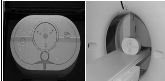
図1 冠動脈石灰化ファントムの CT 撮影 左：ファントムの全体像 右：実際の撮影の様子
